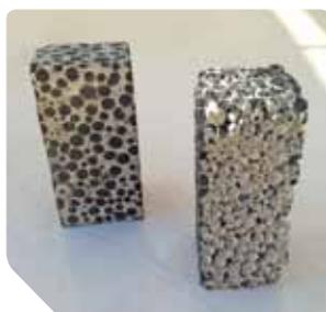
Bétons et granulats d'argiles expansées intégrant de la Bauxaline®
