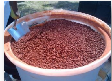
Filtration à base de Bauxaline® modifiée granulée
