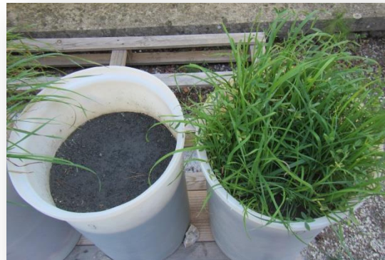
Résidus miniers acides traités à base de Bauxaline ® - Résultats obtenus en mini lysimètres non traité et traité - 78 jours après le semis
